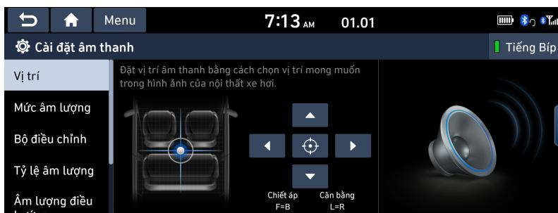
2. Điều chỉnh vị trí âm thanh. Hoặc nhấn [ $\wedge$ ] / [ $\vee$ ] / [ $<$ ] / [ $>$ ] để điều khiển vị trí âm thanh.
