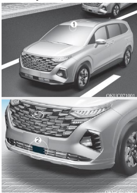
[1]: Camera quan sát phía trước, [2]: Radar phía trước
