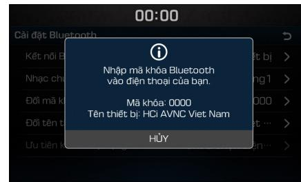
Tùy thiết bị Bluetooth®, tìm tên xe và ghép đôi thiết bị. Khi tìm kiếm từ thiết bị Bluetooth®, tên xe là HCl AVNC Viet Nam và mã khóa mặc định là '0000'.
